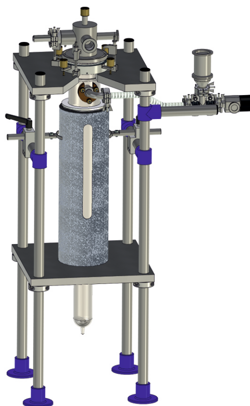
Feststehendes Gestell mit Justiermöglichkeit des LHe Kryostaten, inklusive Sicherheitsstrecke und Kryostatenkopf Fixed frame with adjustment option of the LHe cryostat, including safety section and cryostat head
