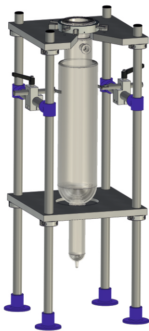
Einfaches Gestell für Kryostate mit Verengung ohne Justierung
