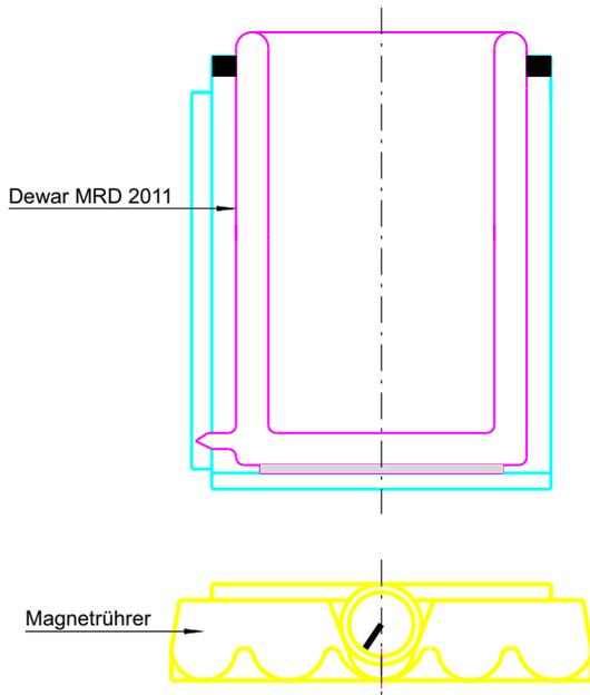
Dewargefäß auf den Magnetrührer aufsetzen und anpressen.
