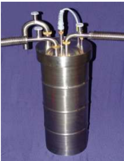
Verdampferdewar mit Temperatur- und Niveauregulierung. Bei diesem Aufbau ist das Kaltgasrohr aus Metall, mit einem Temperierungsmodul für Temperaturen von +50^{\circ}\text{C} bis -150^{\circ}\text{C} . , ohne Temperierungsmodul nur Kühlung bis -170^{\circ}\text{C}
