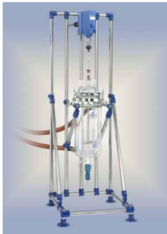
放置在带轮支架上的反应釜
