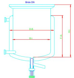
Réacteur avec DN 15 et soupape J
