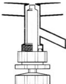
La soupape J est une soupape PTFE pour broches, sans point mort, avec évacuation oblique et ressort de pression, assurant la fermeture sûre en présence de températures élevées et basses. Ouverture standard 10 mm, sur demande 20 mm.
