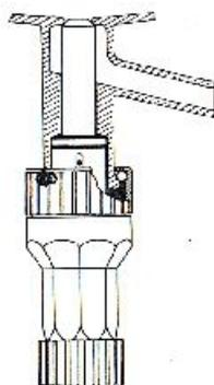
Le raccordement DN15 de l'exemple se compose d'une bride en verre (1) qui est dotée d'un capuchon vissable (2) avec joint d'étanchéité (3) vissé sur l'adaptateur métallique (4).
