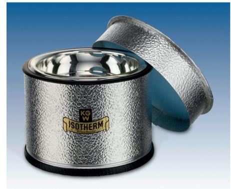
Dewargefäß Typ SCH 30 bis 33 CAL mit ALU/PU Deckel
