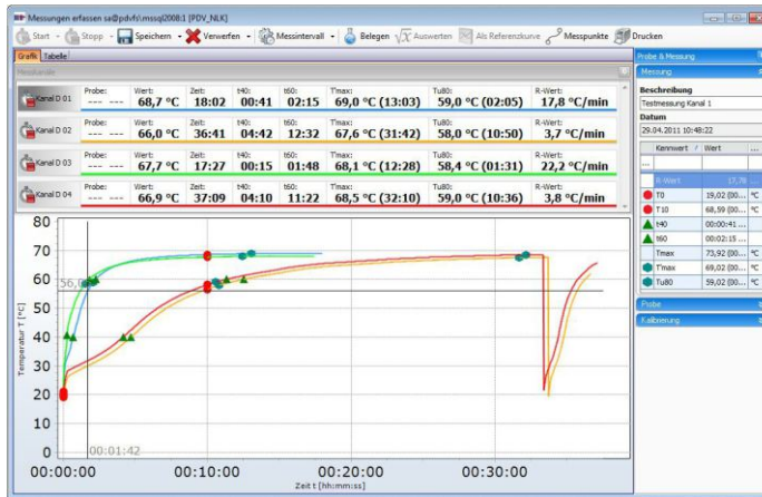
Messdatenerfassung mit nlk 3 der Metalogie GmbH
